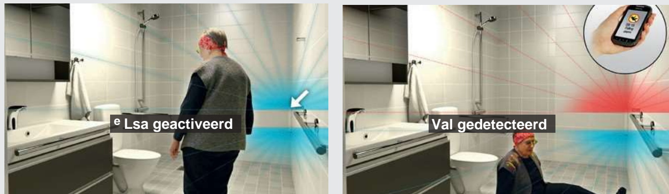
Een valalarm wordt geactiveerd zodra de eLsa alleen beweging signaleert in de onderste sensor.
